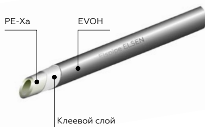
Рис.2 Конструкция труб серии EPU
