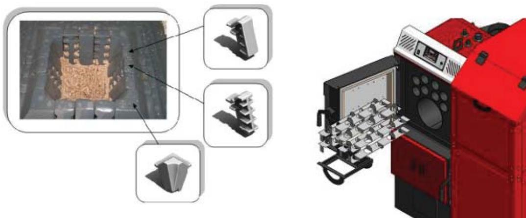
*Извлечение турбулизаторов из котла ECO COMFORT*
