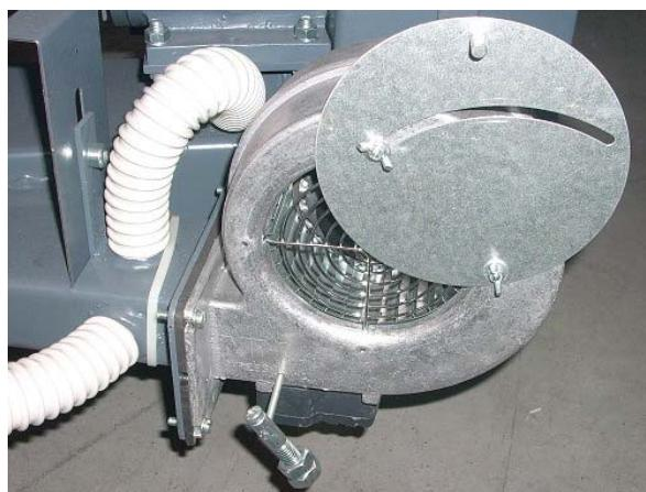
*Положение макс. открытой воздушной заслонки вентилятора*
