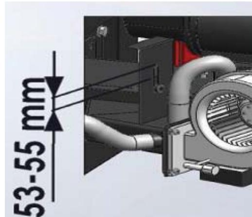
*Положение направляющей воздушной заслонки системы безопасности*
