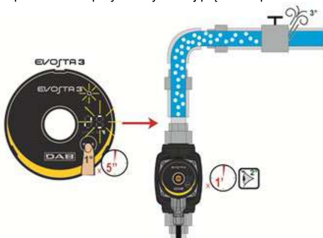
Rysunek 9: Automatyczne odgazowanie pompy
