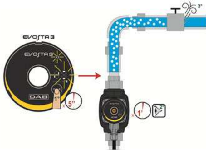
Joonis 9: Pumba automaatne õhutustamine
