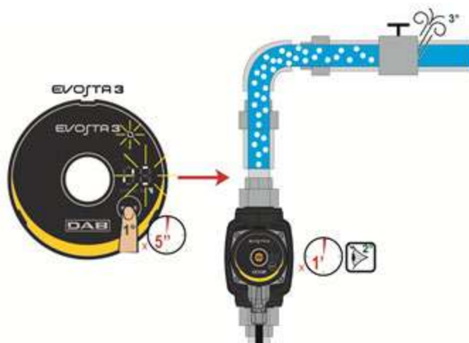
Obrázok 9: Automatické odvzdušnenie čerpadla
