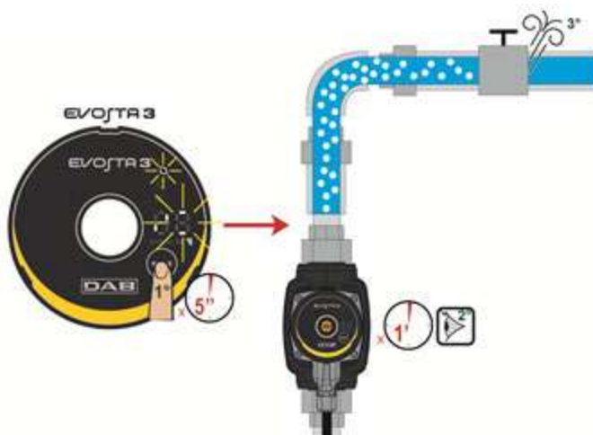
Рисунок 9: Автоматическое удаление воздуха из насоса
