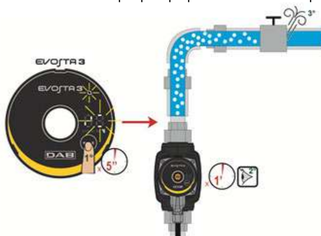
Figura 9: Sfiato automatico della pompa
