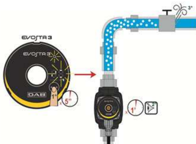
Figura 7: Purga automática de la bomba
