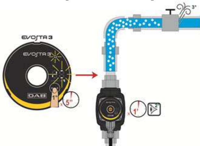
Fig 9: Automatisk avluftning av pumpen
