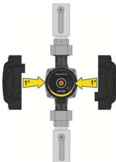
Slika 7: Izolacija ohišja črpalke
