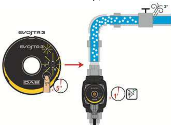
Slika 9: Avtomatska odzračitev črpalke
