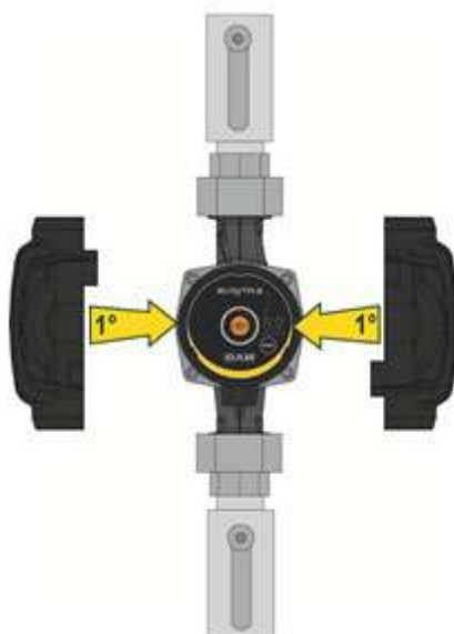
Figura 5: Aislamiento del cuerpo de la bomba
