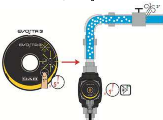
Figura 9: Drenagem automática da bomba
