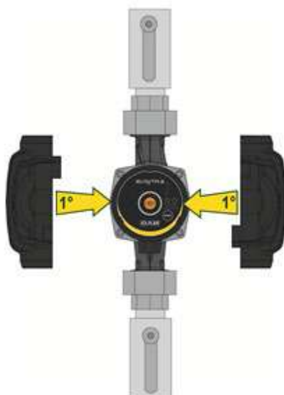
Figura 7: Isolamento do corpo da bomba
