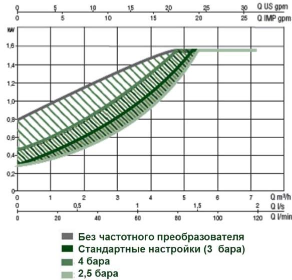
Благодаря плате управления со встроенным частотным преобразователем насос e.sybox mini позволяет значительно экономить на электричестве.
