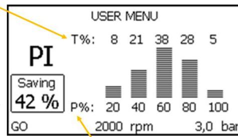
В нижней части отображается мощность (P% потребляемой мощности по отношению к максимальной мощности двигателя).
