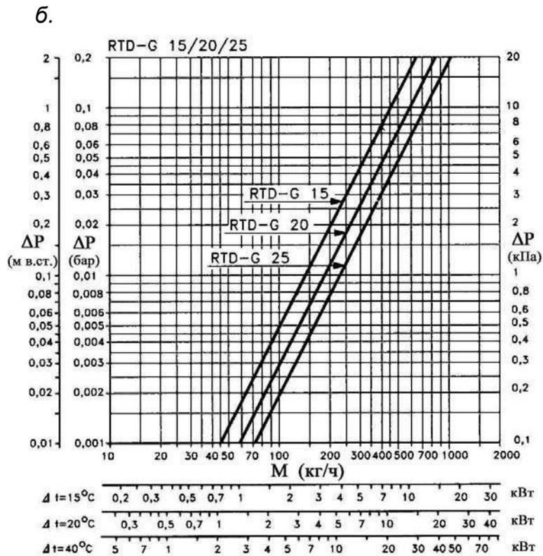
Рис. 2.2. Гидравлические характеристики терморегуляторов фирмы «Данфосс»:
