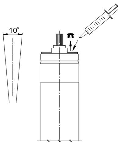
Рис. 9 Максимальный угол наклона двигателя при заливке жидкости.
