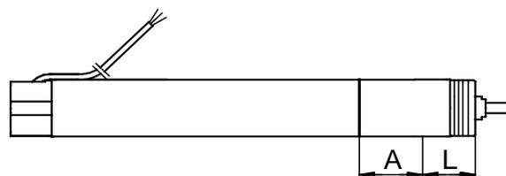
Рис. 5 Область затяжки
