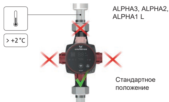
Рис. 17 Возможное положение блока управления для системы отопления
