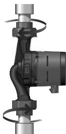
Рис. 3 Монтаж насоса ALPHA3
