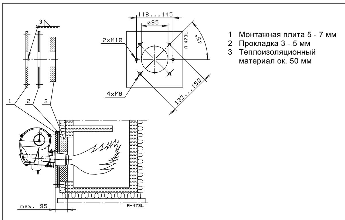
Для крепления горелки к монтажной плите следует просверлить либо 2 шт. отверстия с резьбой M10 либо 4 шт. отверстия с резьбой M8 по чертежу.
