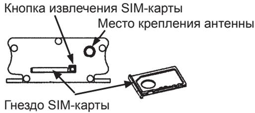
Отожмите маленькую чёрную кнопку на торцевой части модема с помощью шариковой ручки. При этом часть гнезда SIM-карты слегка выдвинется. Извлеките гнездо SIM-карты из модема. Внимание! Не допускается извлечение SIM-карты из модема без предварительного нажатия на кнопку извлечения! Установите SIM-карту в гнездо и убедитесь в том, что карта находится в штатном положении. Вставьте гнездо карты в модем в первоначальное положение.
