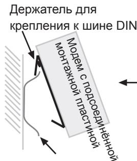
Модем крепится к шине DIN. Закрепите шину DIN на стене или монтажной коробке. В составе модема имеется монтажная пластина для крепления к шине DIN.
