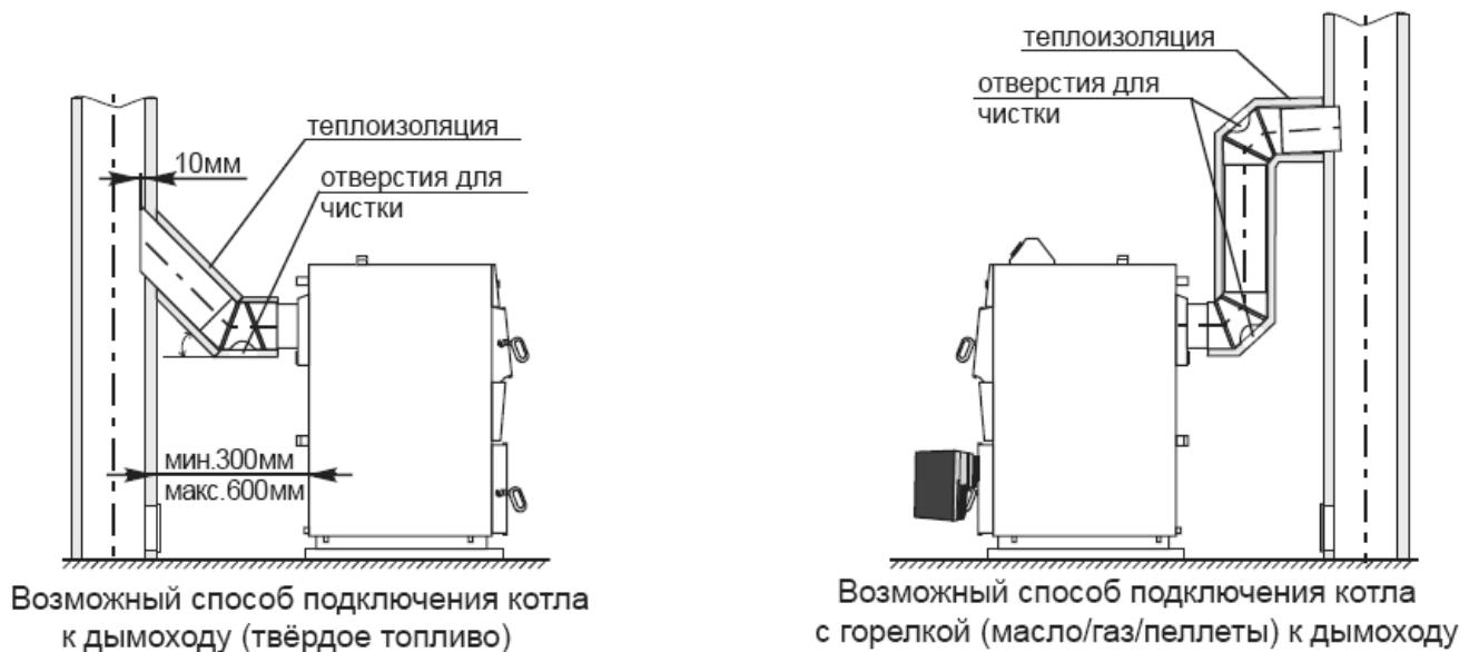
Рисунок 3. Возможный способ подключения котла к дымоходу
