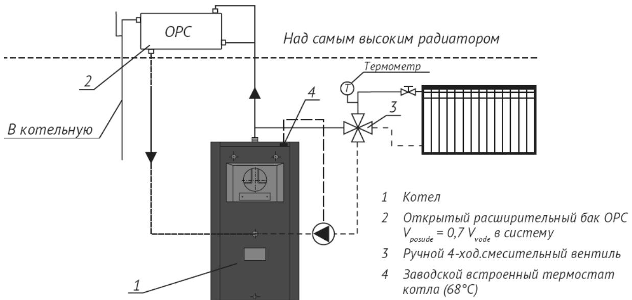
Рисунок 9. Принципиальная схема подключения котла в открытую систему отопления
