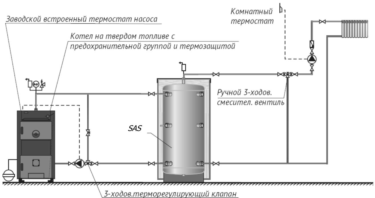
Пример закрытой системы отопления с котлом на твердом топливе, терmostатным 3-ходовым вентилем и аккумулятором тепла SAS. Регулировка комнатной температуры происходит посредством 3-ходового смесительного клапана с ручным управлением.
