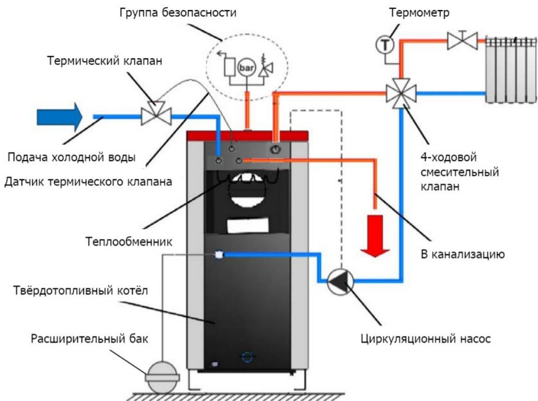
*Рисунок 8. Схема монтажа термозащиты котла в закрытой системе отопления*
