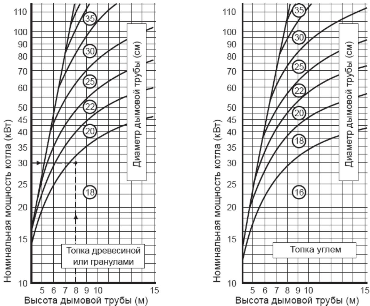
Рисунок 5. Размеры дымохода для котла TK PRO-120 кВт
