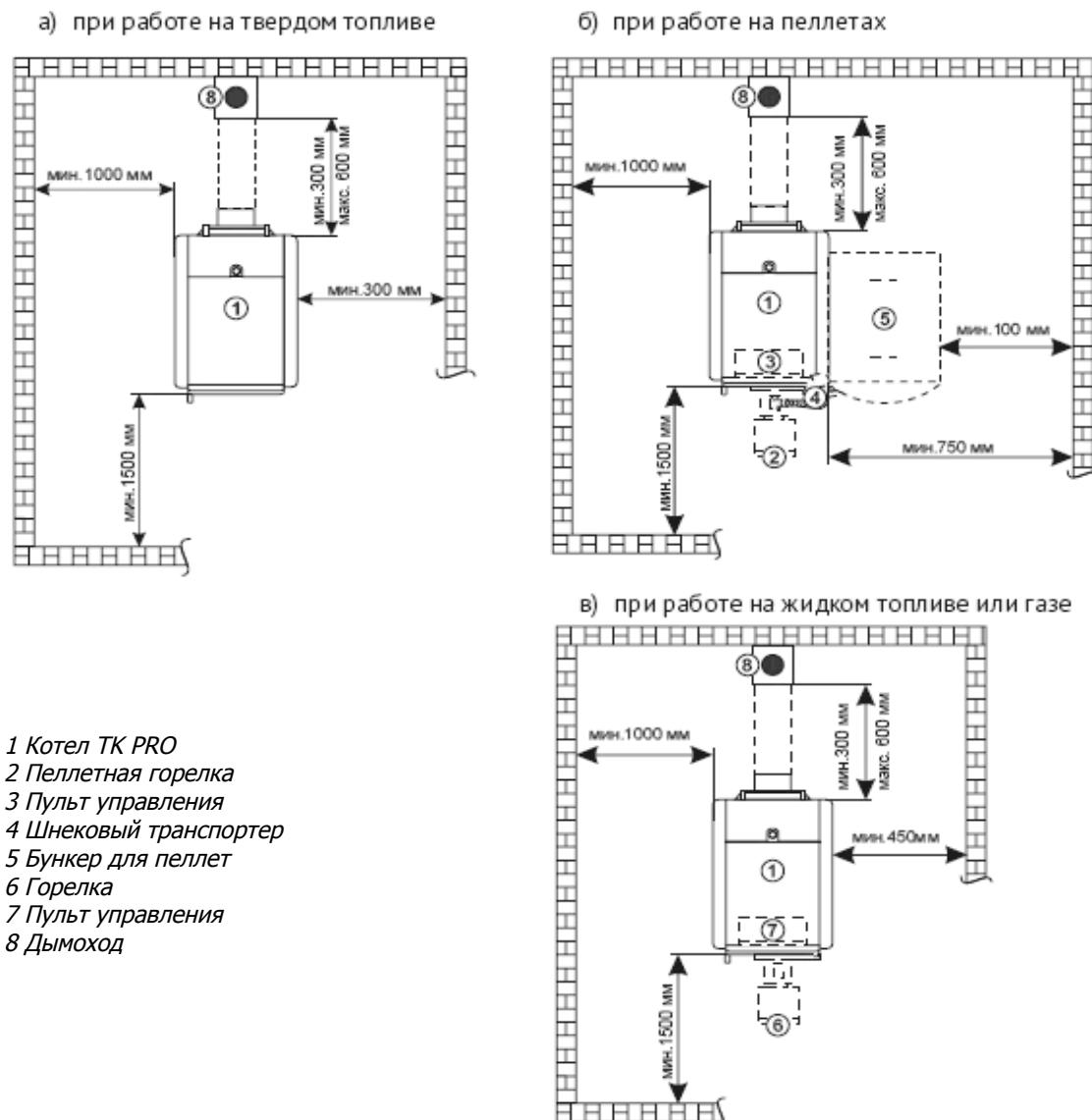
Рисунок 2. Минимальные расстояния от котла до стен котельной
