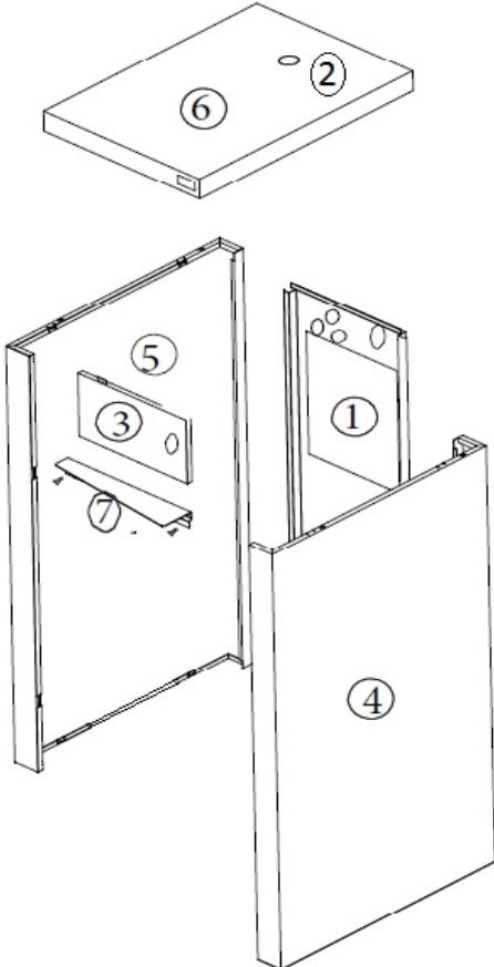
1. Заднюю сторону обшивки (1) надеть на патрубки подключения котла
