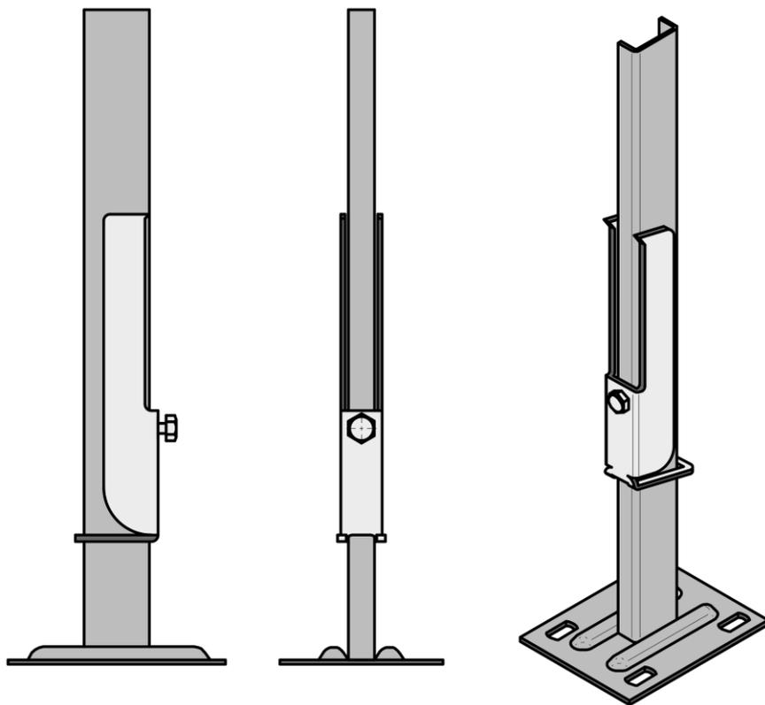
Крепление напольное K11.32 предназначено для напольного монтажа стальных панельных радиаторов Purmo Ventil Compact, Plan Ventil Compact, Plan Ventil Compact D, Ramo Ventil Compact, Ramo Ventil Compact D, 21, 22, 33, 44 типов, высотой 200 мм.
