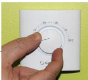
Когда ERT20RF востребует нагрева, красный диод, находящийся под рычагом, начнет гореть. Когда терморегулятор достигнет требуемую температуру светодиод погаснет.
