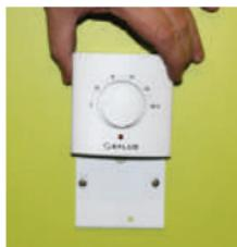
3. После установки передачи радиосигнала (стр. 7) установите переднюю панель на место и убедитесь, что она зацеплена правильно с обеих сторон. Услышите типичный звук "click" подтверждающий надежное зацепление.
