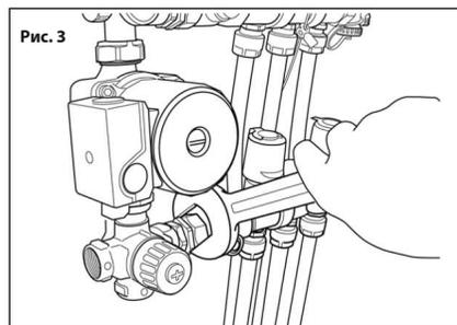
Затянуть окончательно накидные гайки (**рис. 3**) с помощью гаечного ключа 36 мм и соответствующим ключом на шаровые краны коллектора.
