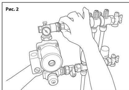
Закрутить верхнюю и нижнюю накидные гайки поочередно по несколько оборотов (**рис. 2**) до упора.
