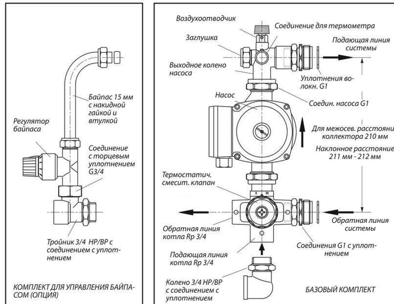
Подходит для тепловой нагрузки до 15 кВт. Этот термостатический смесительный узел для теплых полов с насосом предназначен для прямого подсоединения к отопительным коллекторам с межосевым расстоянием 210 мм и поставляется в полностью собранном виде в левостороннем стандартном варианте с резьбовыми соединениями НР G1 с накидными гайками и торцевыми уплотнениями.
