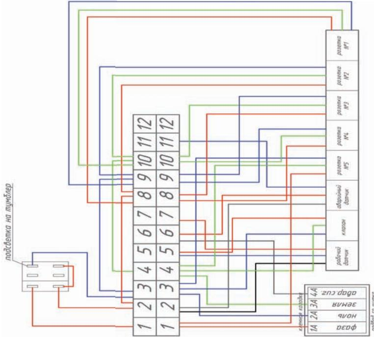
*Схема распайки клеммной колодки
