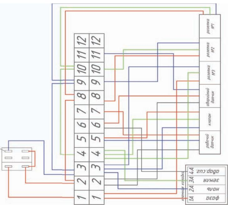
**Схема распайки клеммной колодки
