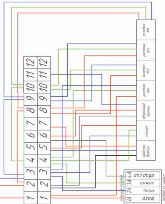
Схема подключения насоса к УОСВ "ТОПАС" Пр
