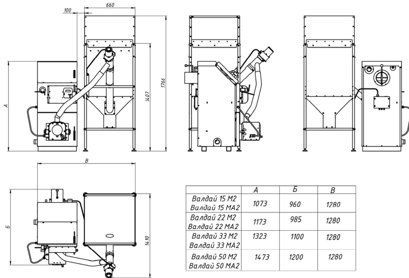
Рис. 3. Габаритные размеры котлов Валдай М2 и Валдай МА2
