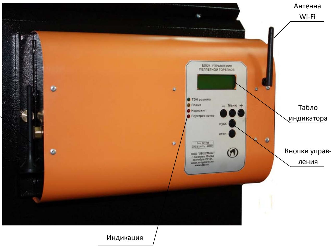
Рис.12. Внешний вид блока управления.
