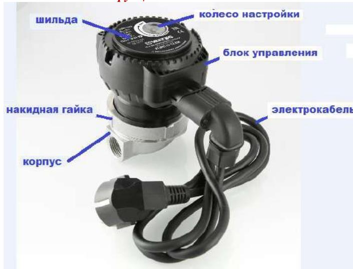
3.1. Циркуляционный насос представляет собой электронасос с однофазным асинхронным электродвигателем со сферическим статором и сферическим «мокрым» ферромагнитным ротором с интегрированным рабочим колесом.
