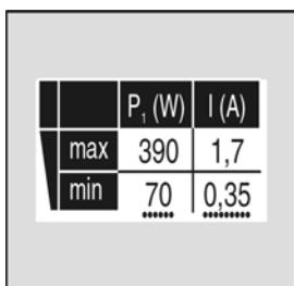
P1max, P1min – Макс. и мин. потребляемые мощности
