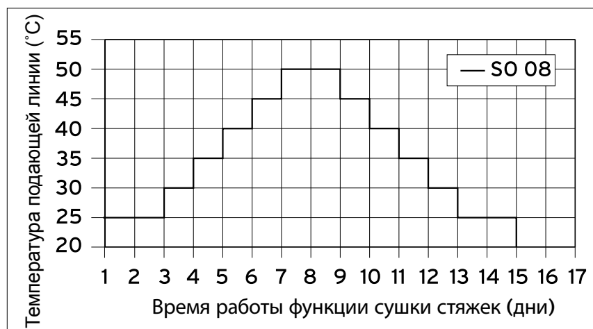
Рис. 6.1 Время выполнения автоматической программы сушки цементных стяжек (параметр SO08 = 50\text{ °C} )
