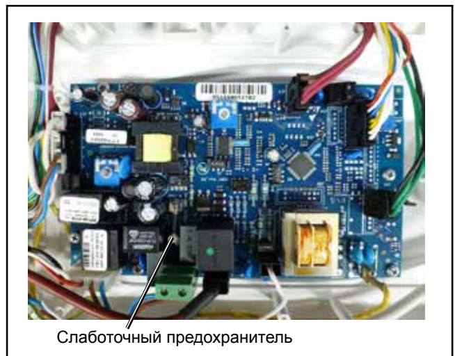
Рис. Замена предохранителей
